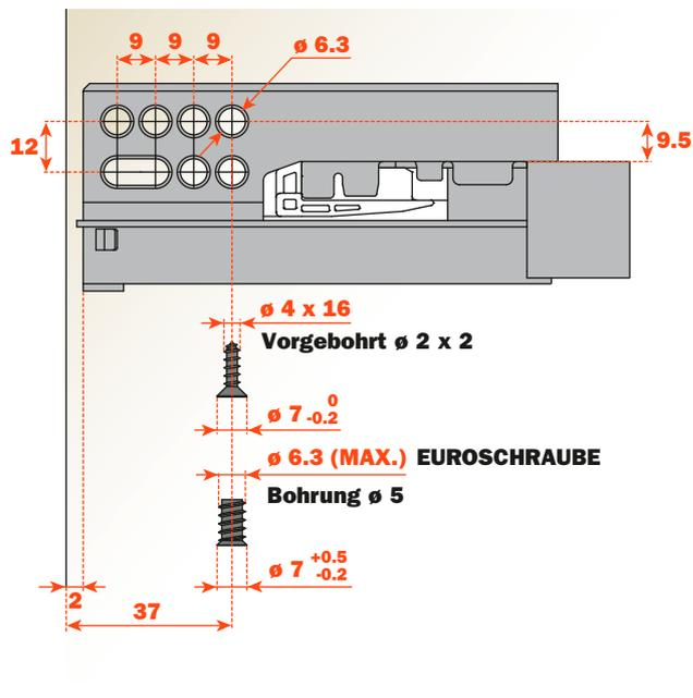
Die ovale Nut erlaubt die Höhenverstellung der Schublade. Dank dieser Nut ist die Ausrichtung der Frontblende von Kommoden mit innenliegenden Schubladen oder mit Futura Push möglich.
