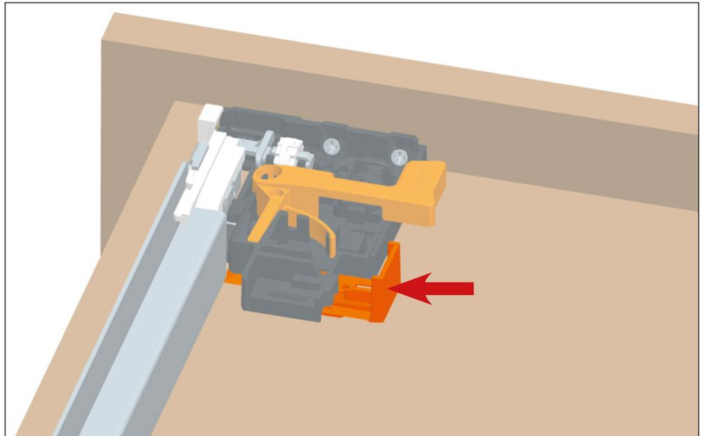
Den Hebel in Richtung Außenseite der Schublade drücken, um die Höhenverstellung zu erreichen.
