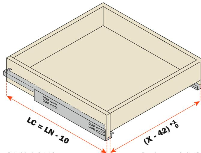
Die Länge der Schublade ist 10 mm weniger als die Länge der Führung
